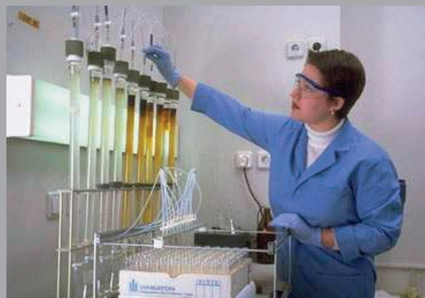
Хроматографическая очистка веществ на сегментных колонках корпорации «ChemBridge»
